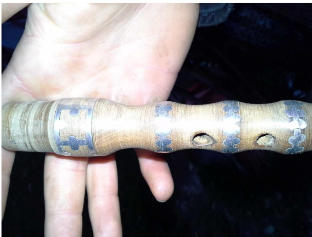
Gajdzica z oblewkami cynowymi po końcowym toczeniu, fot. Ł. Cul
