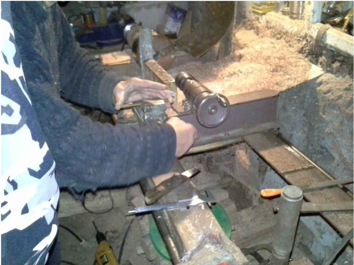
wycinanie mosiężnego korpusu stroika, fot. P. Ficek
